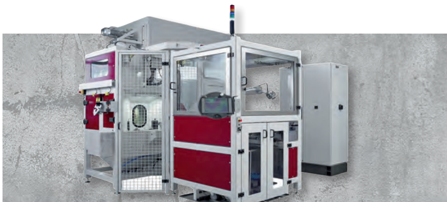
Strahlanlage zur Bearbeitung von technischen Oberflächen.
